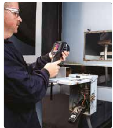
FLIR CM78 trasmette le misurazioni elettriche in tempo reale alle termocamere FLIR IR tramite METERLiNK
