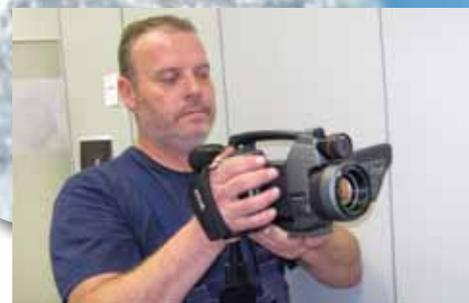
Il tecnico manutentore Thorsten Krämer usa la termocamera FLIR P620 per ispezionare un vano fusibili.
