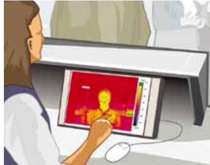
Fase 2: l'operatore con la termocamera IR osserva nel monitor a colori le temperature corporee "fuori norma" segnalate attraverso gli allarmi sonori e/o visivi.
