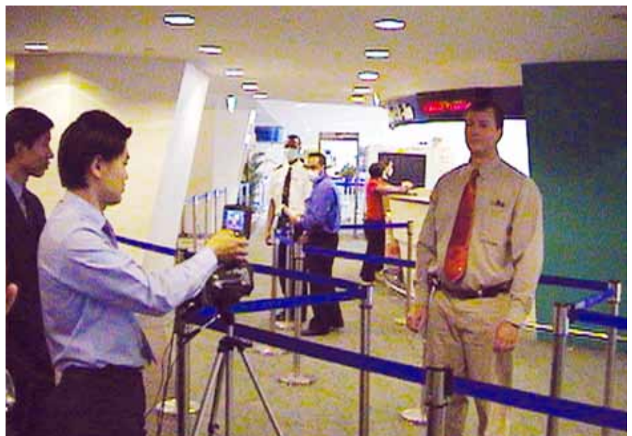
Impostazione di una termocamera ad infrarossi FLIR dotata della funzione di Compensazione Automatica della Temperatura (ATC) per il rilevamento di temperature corporee elevate.
