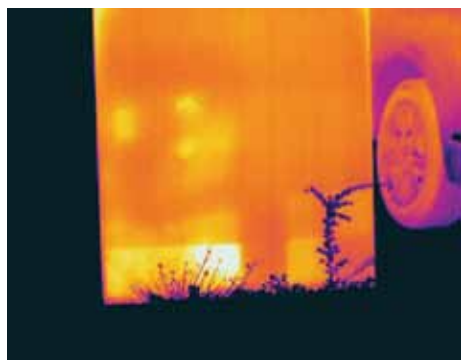
Questi punti caldi sembrano indicare che le celle solari sono inefficienti ma, con un esame più approfondito, si nota che molti punti caldi sono causati dal calore riflesso delle persone davanti al pannello.
