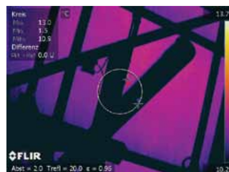
Potrebbe sembrare che i punti caldi su questa immagine ad infrarossi presa dalla parte anteriore del pannello solare indichino che diverse celle non stanno funzionando in modo efficiente.
