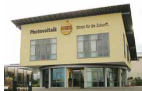
Ogni 10 minuti, l'ultimo piano della sede centrale di Solartechnik Stiens a Kaufungen si muove quasi impercettibilmente per far sì che i pannelli solari sul tetto siano rivolti verso il sole.
