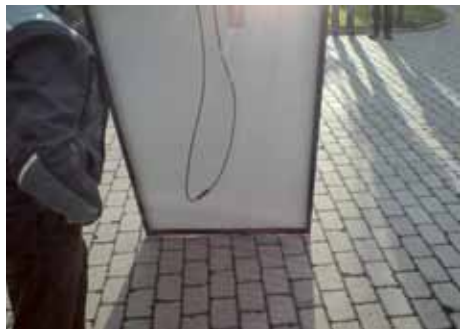
Queste immagini scattate da dietro lo stesso pannello solare mostrano quanto siano inferiori i riflessi rispetto alla parte anteriore, rendendo le misurazioni della temperatura molto più accurate.
