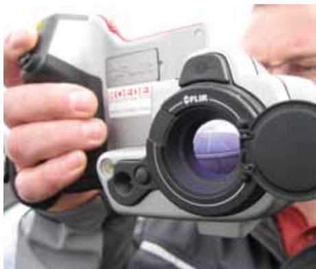
La termocamera FLIR T335 è disponibile con diverse lenti intercambiabili
