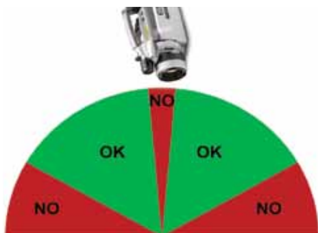
Angolo di osservazione consigliato (verde) e da evitare (rosso) durante le ispezioni ad infrarossi.
