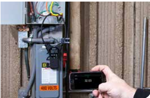
La funzionalità Bluetooth della CM57 per ottenere le letture a distanza di sicurezza
